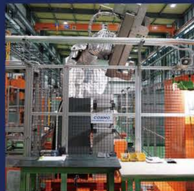
難易度の高い高温の航空機関連部品を取り扱うロボット
